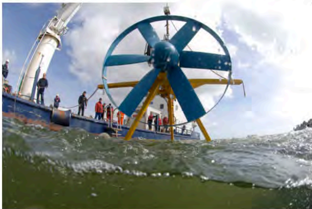
Ouessant sera alimenté par deux hydroliennes Sabella de 1MW.
